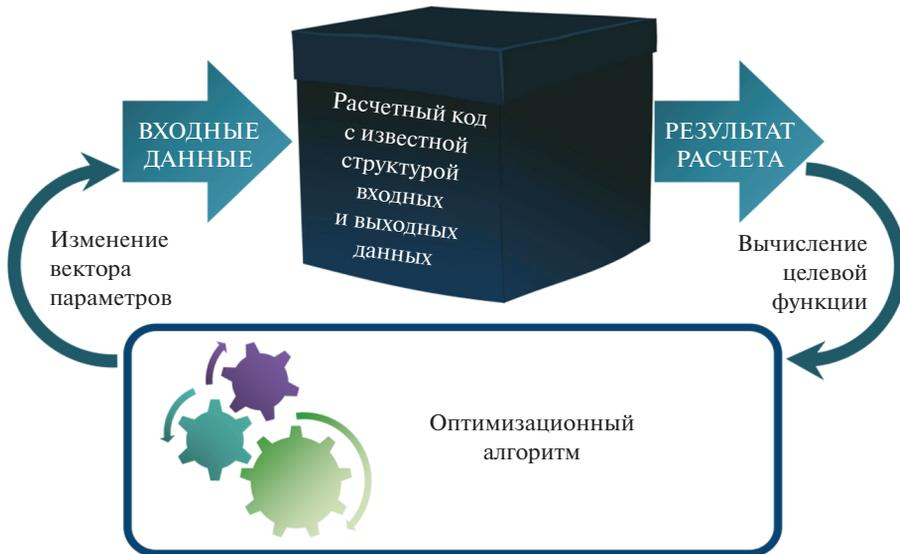
**Рис. 2.** Схема взаимодействия оптимизационного алгоритма и расчетного кода, осуществляющего численное моделирование.
