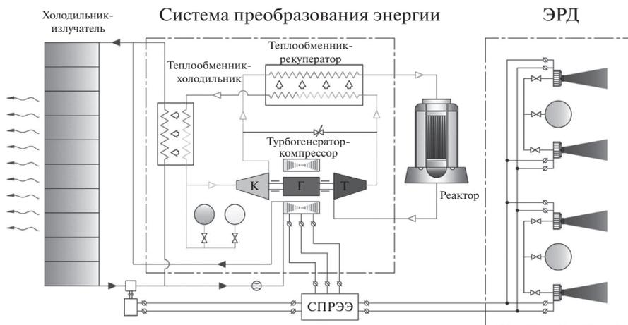
Рис. 1. Схема ЭДУ с газотурбинной системой преобразования энергии и ядерным реактором.
