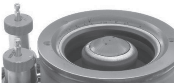
Рис. 8. Внешний вид двигателя КМ-75 после 2000 ч ресурсных испытаний.
