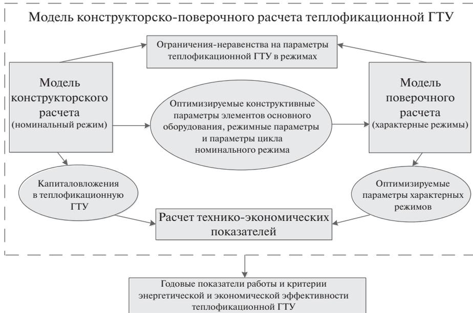
Рис. 2. Блок-схема расчета теплофикационной ГТУ.
