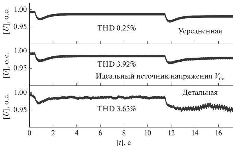
Рис. 12. Осциллограммы фазного среднеквадратичного значения мгновенного напряжения в точке подключения СНЭ [6].
