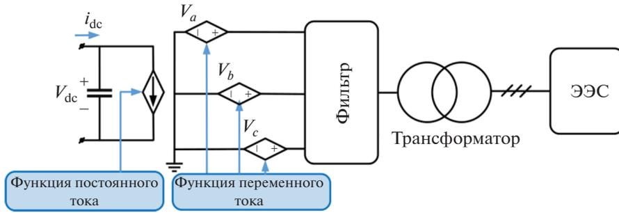
Рис. 9. Моделирование СНЭ с “усредненной” моделью СПН.
