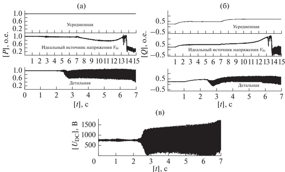
**Рис. 14.** Осциллограммы переходного процесса при увеличении реактивной мощности нагрузки и отключении одного из энергоблоков для полной модели [6]: (а) активная мощность; (б) реактивная мощность; (в) напряжение цепи постоянного тока.
