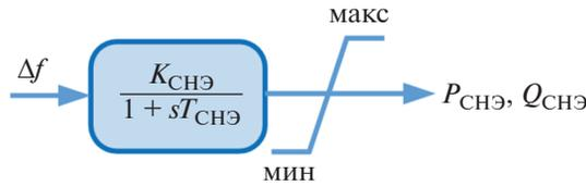
**Рис. 4.** Модель НЭ в виде апериодического звена первого порядка:  $T_{CHЭ}$  – постоянная времени НЭ;  $K_{CHЭ}$  – коэффициент усиления;  $Q_{CHЭ}$  и  $P_{CHЭ}$  – активная и реактивная выходная мощность НЭ.
