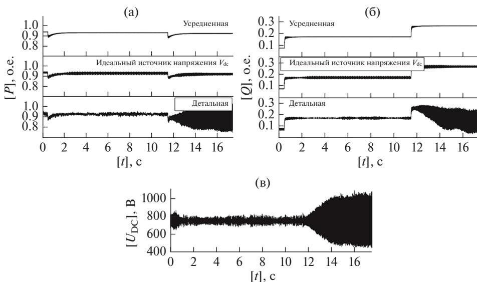
Рис. 13. Осциллограммы переходного процесса при увеличении нагрузки в ЭЭС с СНЭ с шагом 100 кВар в  $t = 0.5$  с и  $t = 11.5$  с [6]: (а) активная мощность; (б) реактивная мощность; (в) напряжение цепи постоянного тока.
