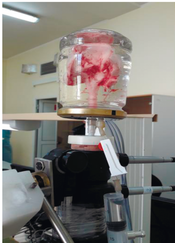
Рис. 2. Измерение импедансных характеристик изолированных легких в герметичном сосуде, заполненном водой.
