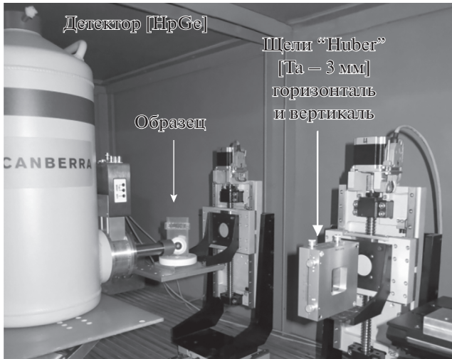
Рис. 2. Фотография экспериментального объема станции РФА-СИ на ВЭПП-4М.
