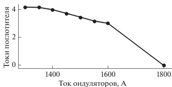
Рис. 5. Эксперимент: согласование параметров Твисса.
