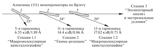
Рис. 1. Схема расположения “полупрозрачных” монохроматоров станции “Микрофокус” (вид сверху).
