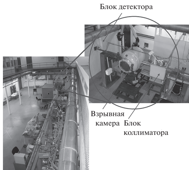
Рис. 1. Внешний вид канала СИ № 8 на накопителе ВЭПП-4М и станции “Детонация-2”.
