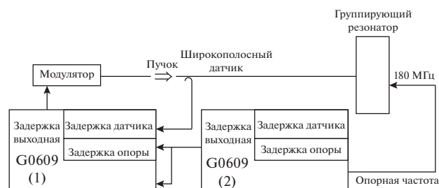
Рис. 2. Модифицированная схема запуска модулятора электронных сгустков.
