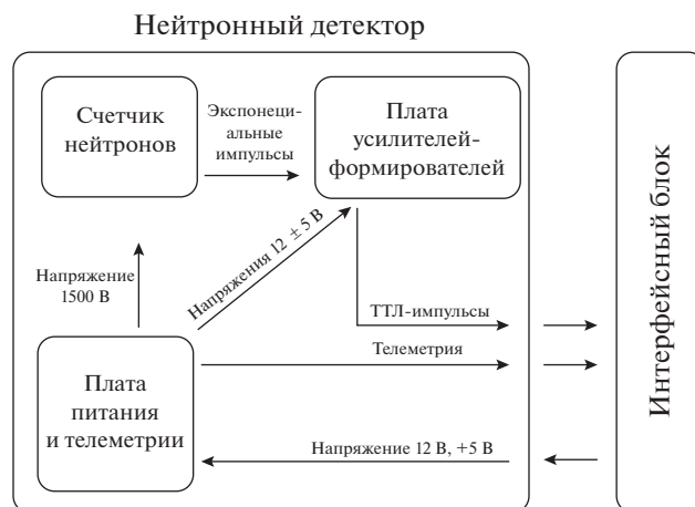
Рис. 1. Блок-схема основных элементов нейтронного детектора и его взаимодействия с интерфейсным блоком.
