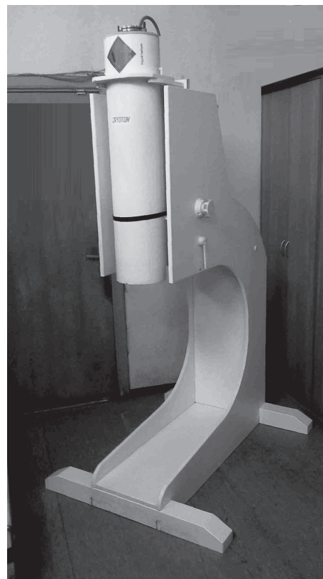
Рис. 1. Фотография криостата с измерительным зондом на стойке его крепления и перемещения в стенде для исследования магнитокардиосигналов человека.
