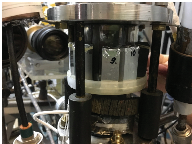
Рис. 2. Расположение контейнеров с биологическими объектами вокруг кварцевой стенки разрядно-взрывной камеры.
