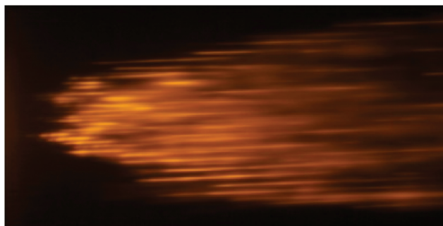
Рис. 1. Картина распределения интенсивности фотолюминесценции дефектов в головной части канала, наведенного одиночным импульсом. Толщина канала на максимуме достигает ~1.8 мм.
