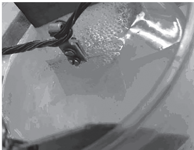
Рис. 2. Образование газообразного кислорода на аноде при окислении алюминия в 15% растворе NaCl, при 40^\circ\text{C} , катод нержавеющая сталь X18H9T.
