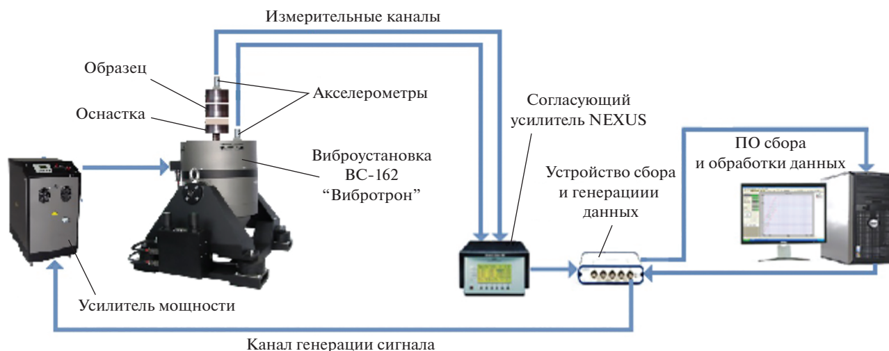
Рис. 1. Функциональная схема экспериментальной установки.
