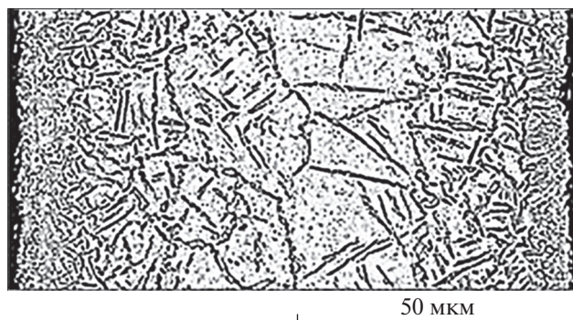
Рис. 5. Микроструктура поперечного сечения ленты (Nb–Zr)-сплава после ТО под давлением при 1500°C в течение 45 мин.
