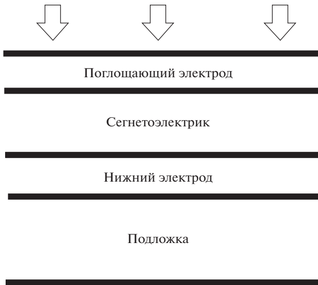
Рис. 1. Схематическое изображение исследуемого образца. Поглощающий электрод – пироэлектрик – электрод ИТО – подложка.
