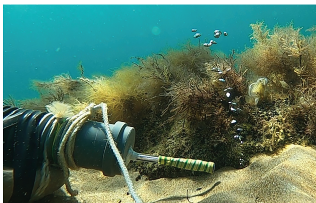
Рис. 3. Подводная фотография гидрофона, установленного рядом с точкой пузырьковых газовыделений в бухте Ласпи.
