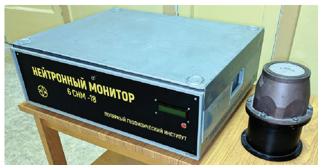
Рис. 1. Портативный комплекс для мониторинга вторичных космических лучей, использованный в экспедиции. Детектор гамма-излучения стоит справа, он является внешним прибором, подключаемым к комплексу.
