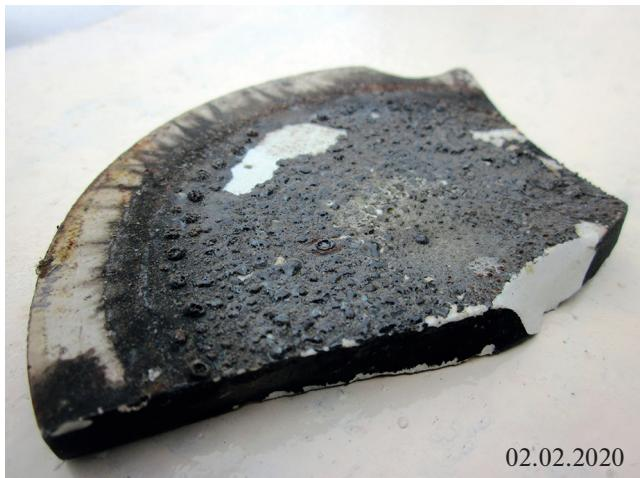
**Рис. 3.** Фотография результата воздействия теплового удара на ситалл.
