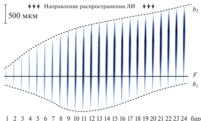
Рис. 3. Зависимость положения и яркости свечения ЛИП от давления аргона в рабочем сосуде, направление распространения ЛИ сверху вниз. F — фокальная плоскость, b_1 — передняя граница ЛИПК, b_2 — задняя граница ЛИПК [22].
