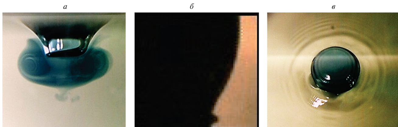
Рис. 1. Погружение капли водного раствора чернил (концентрация 1 : 200, \rho = 1 \text{ г} \cdot \text{см}^{-3} , \sigma = 73 \text{ г} \cdot \text{с}^{-2} , \nu = 0.01 \text{ г} \cdot \text{см}^{-1} \cdot \text{с}^{-1} ) в режиме интрузии: а) задержка формирования каверны, б) пелена в области слияния капли с принимающей жидкостью (вид сбоку), в) капиллярные волны на поверхности капли и принимающей жидкости (вид сверху). Скорость капли U = 0.34 \text{ м/с} , E_\sigma = 4 \text{ мкДж} , E_k = 2.24 \text{ мкДж} , Re = 1450 , Fr = 2.8 , We = 6.7 , Bo = 2.5 , Oh = 0.0018 .
