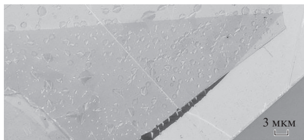
Рис. 4. Фотография структуры \text{hBN-MoSe}_2\text{-hBN} на подложке \text{Si/SiO}_2 полученная СЭМ. Хорошо видны пузыри субмикронного размера на интерфейсах.
