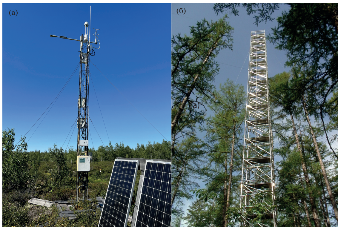
Рис. 3. Типичные измерительные комплексы RuFlux: (а) на плоскобугристом болоте (высота вышки 6 м, станция KR-Iga) и (б) в лесу (высота вышки 34 м, станция YA-Elg).
