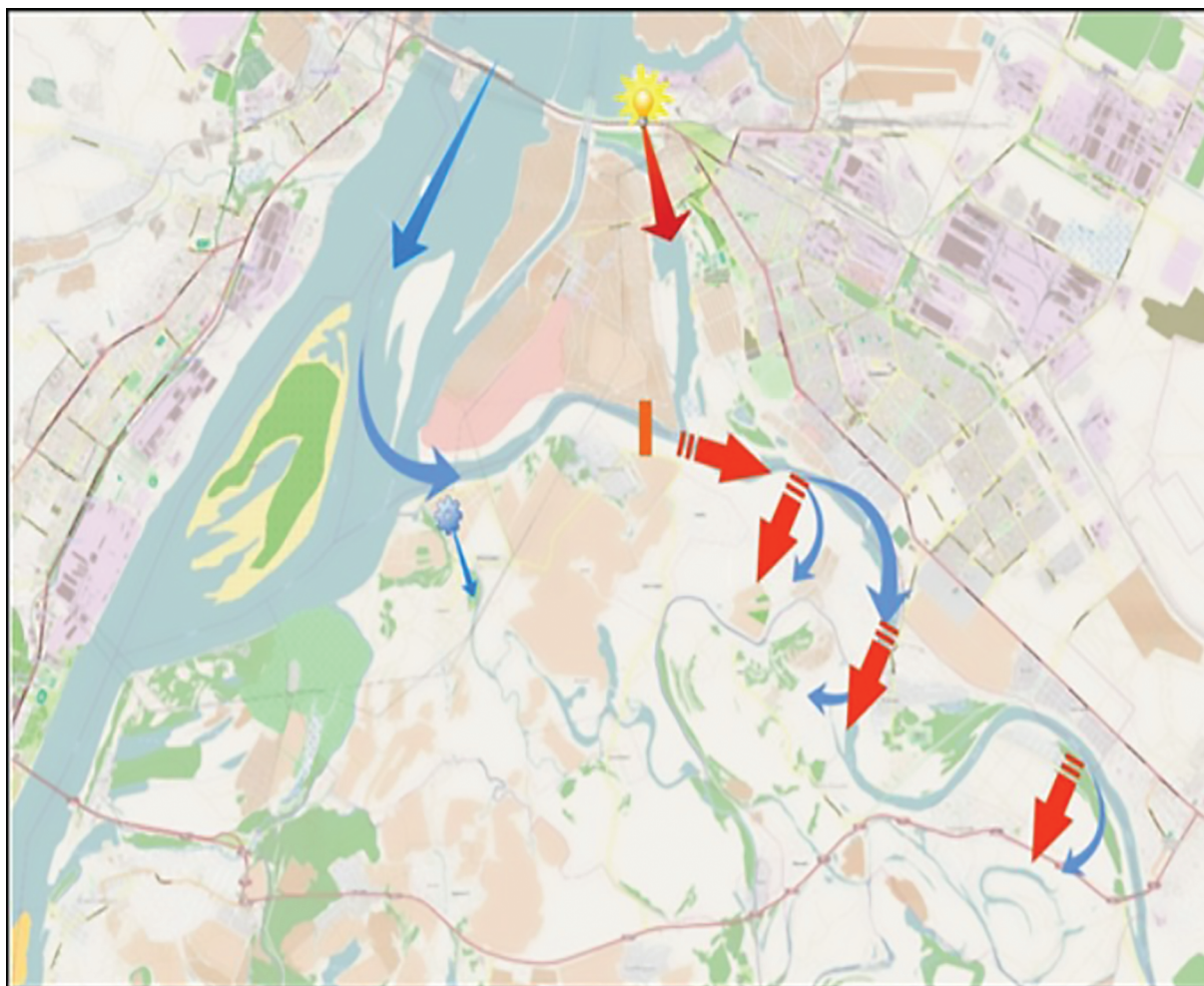
Рис. 1. Принципиальная схема дополнительной водоподачи в систему водных объектов Волго-Ахтубинской поймы (синие стрелки — направление потока в период весеннего половодья, красные стрелки — направление подачи воды в период летней межени за счет механической подачи).
