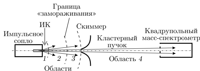
Рис. 1. Формирование кластерного пучка в условиях импульсной струи (подробнее см. текст)
