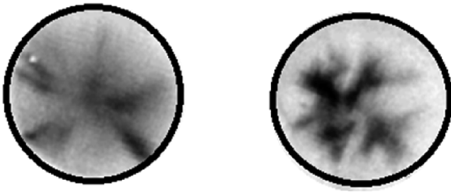
Рис. 2. Примеры интегральных по времени рентгеновских изображений области кумуляции плазмы в центре МОК, зарегистрированных через отверстия ввода ЛИ диаметром 0.6 мм
