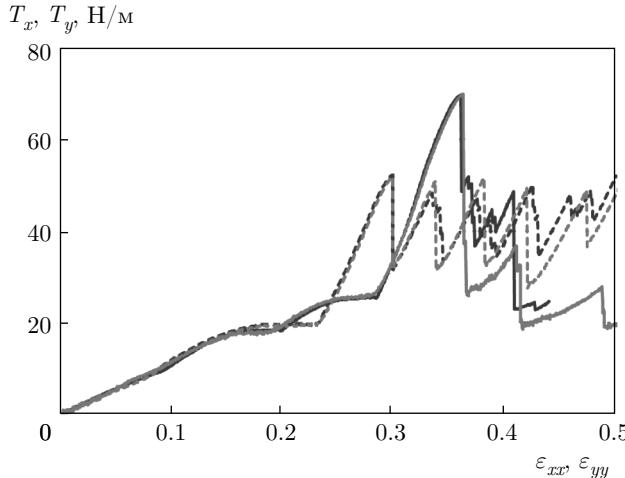
**Рис. 4.** Мембранные усилия  $T_x$  и  $T_y$  в структуре Gr1 как функции одноосной деформации соответственно  $\varepsilon_{xx}$  при  $\varepsilon_{yy} = 0$  и  $\varepsilon_{yy}$  при  $\varepsilon_{xx} = 0$ . Растяжение вдоль оси  $x$  ( $y$ ) показано сплошными (штриховыми) линиями. Синие (красные) кривые соответствуют деформированию при 10 К (300 К)
