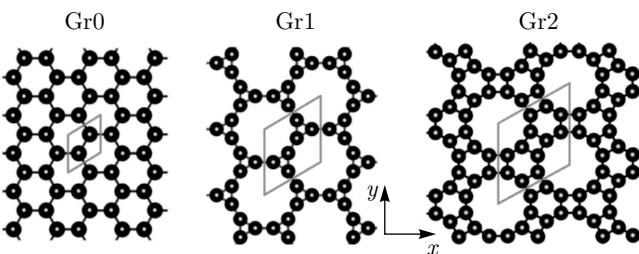
**Рис. 1.** Структура графена (Gr0) и двух других  $sp^2$ -структур углерода, исследованных в данной работе. Выделены трансляционные ячейки, содержащие 2, 6, 12 атомов углерода соответственно в структурах Gr0, Gr1, Gr2
