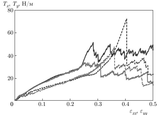
**Рис. 5.** Мембранные усилия  $T_x$  и  $T_y$  в структуре Gr2 как функции одноосной деформации соответственно  $\varepsilon_{xx}$  при  $\varepsilon_{yy} = 0$  и  $\varepsilon_{yy}$  при  $\varepsilon_{xx} = 0$ . Растяжение вдоль оси  $x$  ( $y$ ) показано сплошными (штриховыми) линиями. Синие (красные) кривые соответствуют деформированию при 10 К (300 К)
