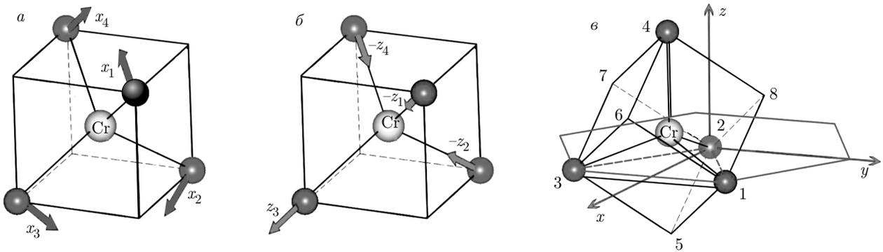
Рис. 3. (В цвете онлайн) Искажения комплекса  $\text{CrSe}_4$  по координатам  $Q_v$  (а),  $\frac{1}{\sqrt{3}}(Q_\xi + Q_\eta + Q_\zeta)$  (б) и положение комплекса в декартовой системе координат, связанной с кристаллической решеткой (в)
