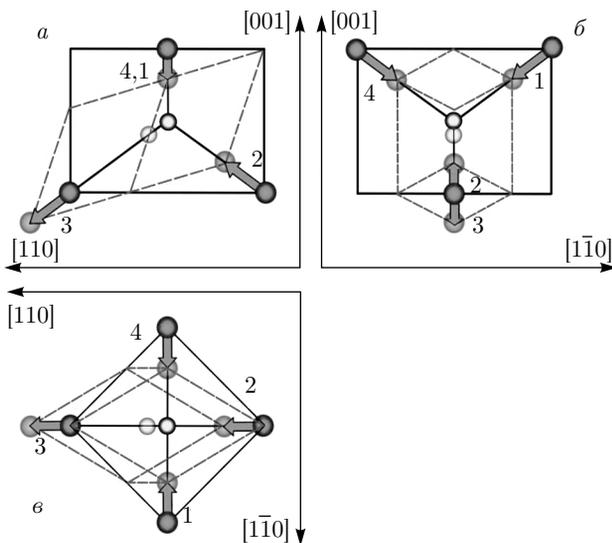
**Рис. 5.** (В цвете онлайн) Тригональные искажения комплекса по симметризованной координате  $(Q_\xi + Q_\eta + Q_\zeta)/\sqrt{3}$ , представленные в проекциях на плоскости, заданные в декартовой системе координат, связанной кубом:  $a$  — на плоскость  $([110], [001])$ ;  $b$  —  $([001], [1\bar{1}0])$ ;  $v$  —  $([110], [1\bar{1}0])$ . Штриховыми линиями показана искаженная конфигурация куба
