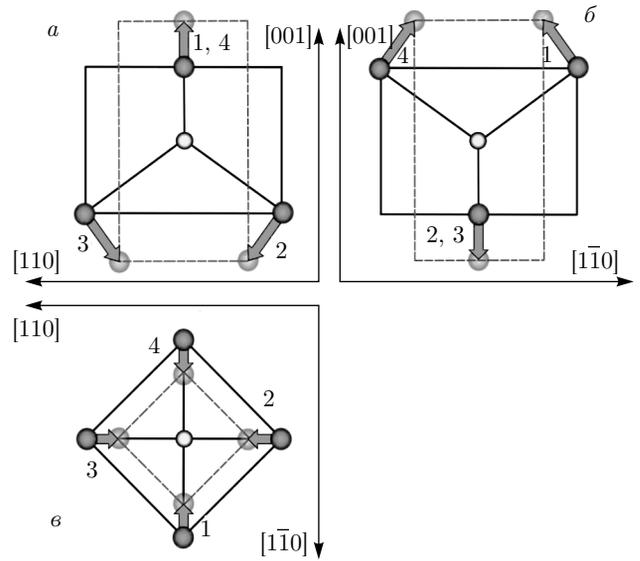
**Рис. 4.** (В цвете онлайн) Тетрагональные искажения комплекса по симметрийной координате  $Q_\vartheta$ , представленные в проекциях на плоскости, заданные в декартовой системе координат, связанной кубом:  $a$  — на плоскость  $([110], [001])$ ;  $b$  —  $([001], [\bar{1}10])$ ;  $v$  —  $([110], [1\bar{1}0])$ . Штриховыми линиями показана искаженная конфигурация куба
