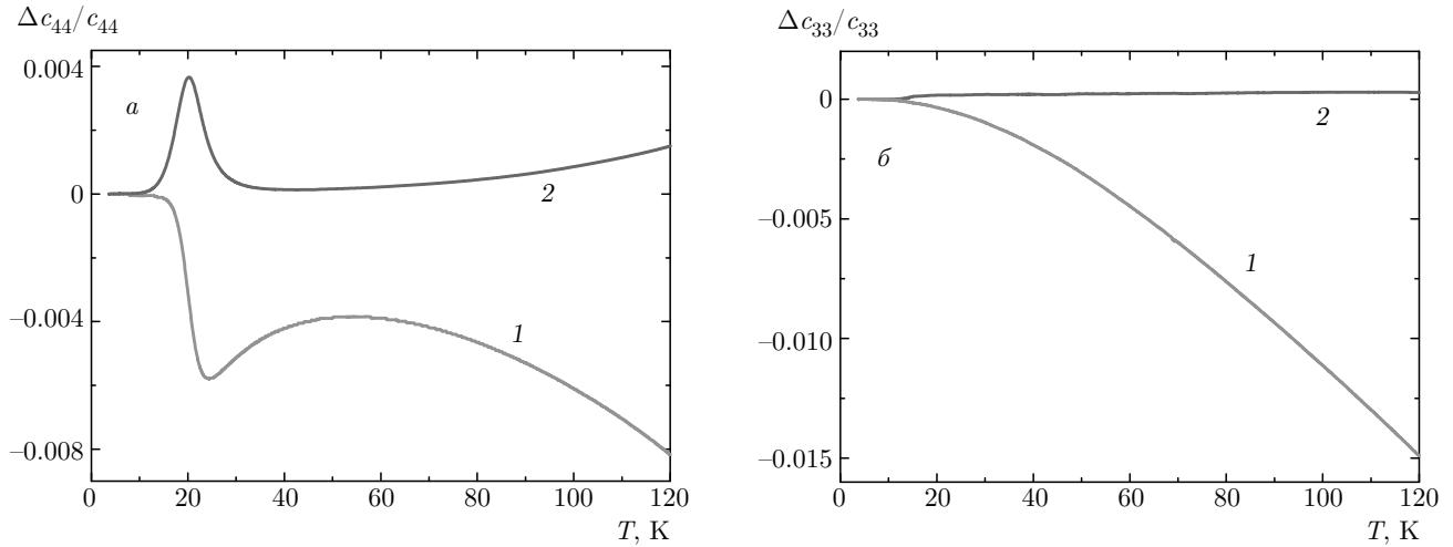
**Рис. 2.** Температурные зависимости действительной (кривая 1) и мнимой (2) составляющих динамических модулей упругости  $c_{44}$  (а) и  $c_{33}$  (б) в кристалле CdSe:Cr<sup>2+</sup>;  $\Delta c_{ii}/c_{ii} = [c_{ii}(T) - c_{ii}(T_0)]/c_{ii}(T_0)$ ,  $T_0 = 3.7$  К (а) и  $T_0 = 3.8$  К (б), частота  $\omega/2\pi = 55$  МГц
