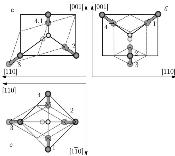
**Рис. 5.** (В цвете онлайн) Тригональные искажения комплекса по симметризованной координате  $(Q_\xi + Q_\eta + Q_\zeta)/\sqrt{3}$ , представленные в проекциях на плоскости, заданные в декартовой системе координат, связанной кубом:  $a$  — на плоскость  $([110], [001])$ ;  $b$  —  $([001], [1\bar{1}0])$ ;  $c$  —  $([110], [1\bar{1}0])$ . Штриховыми линиями показана искаженная конфигурация куба
