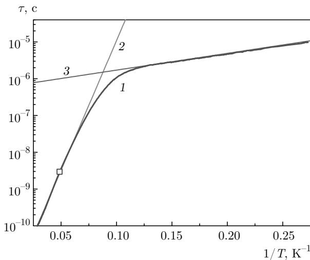
**Рис. 7.** Температурная зависимость времени релаксации (кривая 1), полученная на основе данных о поглощении нормальной моды, связанной с модулем  $c_{44}$ , измеренным на частоте  $\omega/2\pi = 55$  МГц. Линия 2 соответствует зависимости  $\tau_1(T) = 10^{-12} \exp(162/T)$ , линия 3 —  $\tau_2(T) = 6 \cdot 10^{-7} \exp(10.5/T)$ , а квадрат соответствует значению  $\tau(T_1)$
