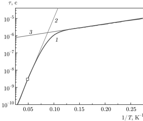
**Рис. 7.** Температурная зависимость времени релаксации (кривая 1), полученная на основе данных о поглощении нормальной моды, связанной с модулем  $c_{44}$ , измеренным на частоте  $\omega/2\pi = 55$  МГц. Линия 2 соответствует зависимости  $\tau_1(T) = 10^{-12} \exp(162/T)$ , линия 3 —  $\tau_2(T) = 6 \cdot 10^{-7} \exp(10.5/T)$ , а квадрат соответствует значению  $\tau(T_1)$
