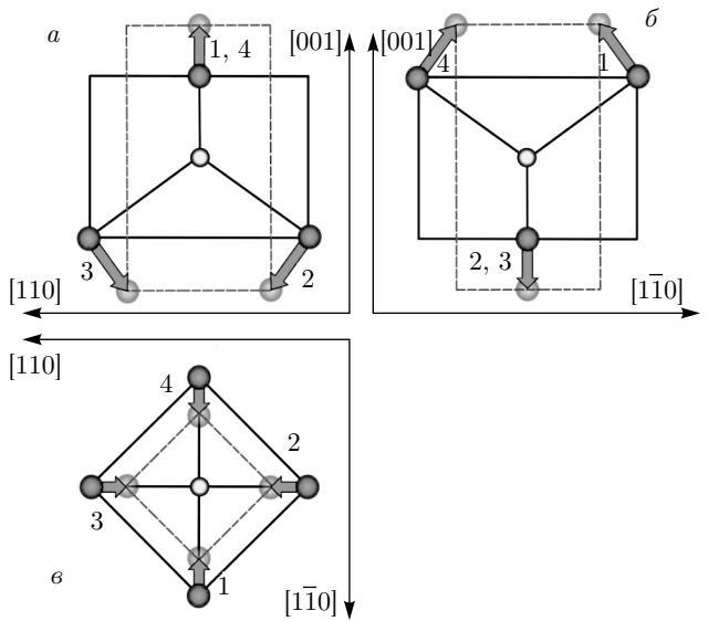
**Рис. 4.** (В цвете онлайн) Тетрагональные искажения комплекса по симметрийной координате  $Q_\vartheta$ , представленные в проекциях на плоскости, заданные в декартовой системе координат, связанной кубом: *а* — на плоскость  $([110], [001])$ ; *б* —  $([001], [\bar{1}10])$ ; *в* —  $([110], [1\bar{1}0])$ . Штриховыми линиями показана искаженная конфигурация куба
