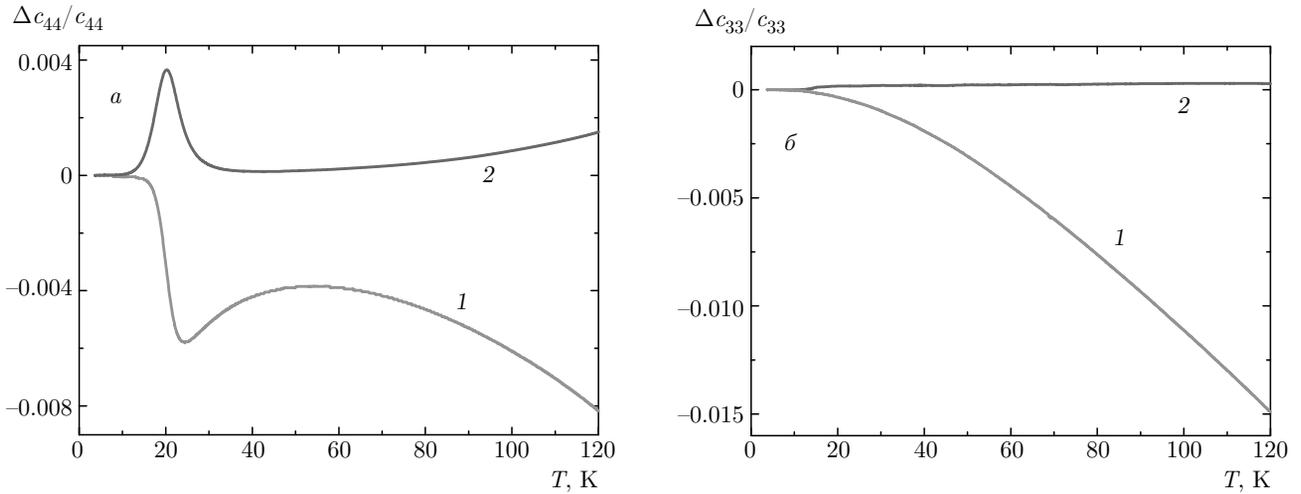
Рис. 2. Температурные зависимости действительной (кривая 1) и мнимой (2) составляющих динамических модулей упругости  $c_{44}$  (а) и  $c_{33}$  (б) в кристалле  $\text{CdSe}:\text{Cr}^{2+}$ ;  $\Delta c_{ii}/c_{ii} = [c_{ii}(T) - c_{ii}(T_0)]/c_{ii}(T_0)$ ,  $T_0 = 3.7$  К (а) и  $T_0 = 3.8$  К (б), частота  $\omega/2\pi = 55$  МГц
