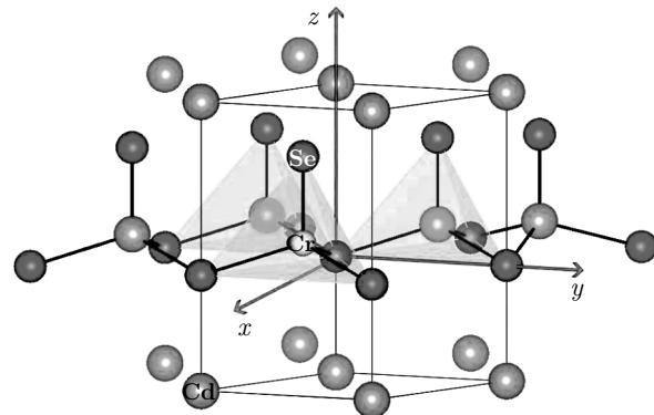
Рис. 1. (В цвете онлайн) Кристаллическая решетка типа вюрцита с примесью хрома, замещающей ион металла в тетраэдрическом окружении
