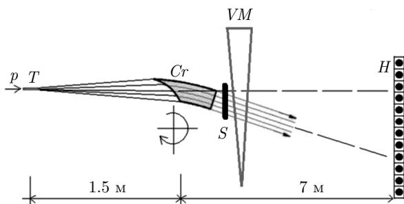
**Рис. 6.** Схема опыта:  $T$  — мишень из CsI;  $Cr$  — кристалл в гониометре;  $S$  — миниатюрный сцинтиллятор;  $VM$  — вертикальный магнит;  $H$  — сцинтиляционный детектор
