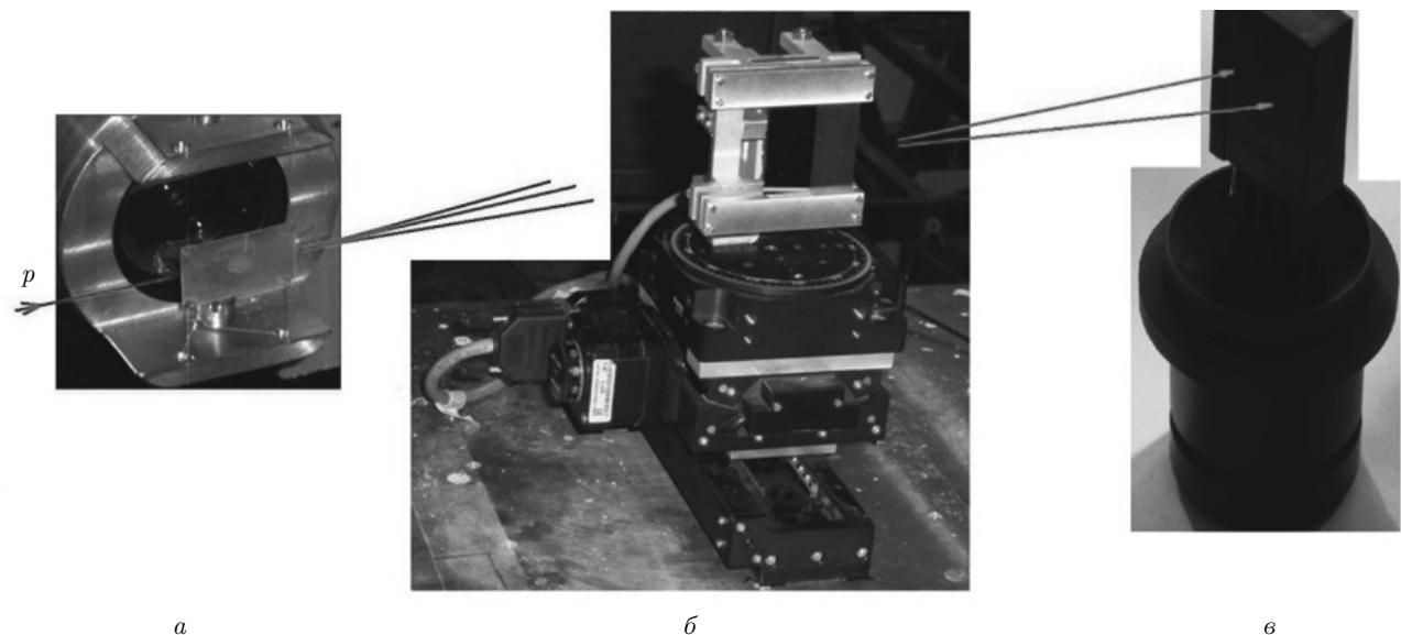
**Рис. 7.** Внешний вид основных элементов установки: *а* — активная мишень для рождения  $\pi$ -мезонов; *б* — фокусирующий кристалл в гониометре; *в* — сцинтиляционный гадоскоп на многоканальном ФЭУ для регистрации эффекта
