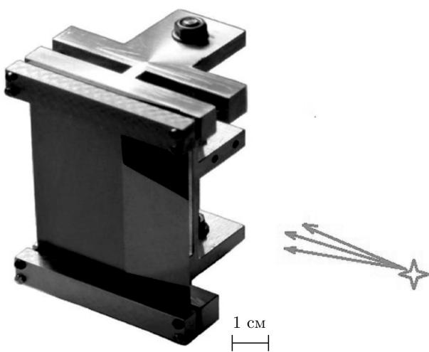
**Рис. 2.** Внешний вид кристаллического фокусирующего устройства
