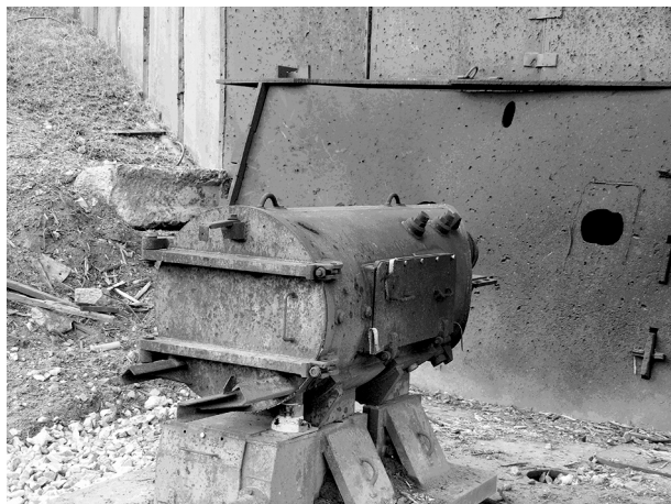
Рис. 8. Взрывозащищенная камера, используемая для размещения регистров изображений рентгенографируемого устройства при проведении взрывных экспериментов
