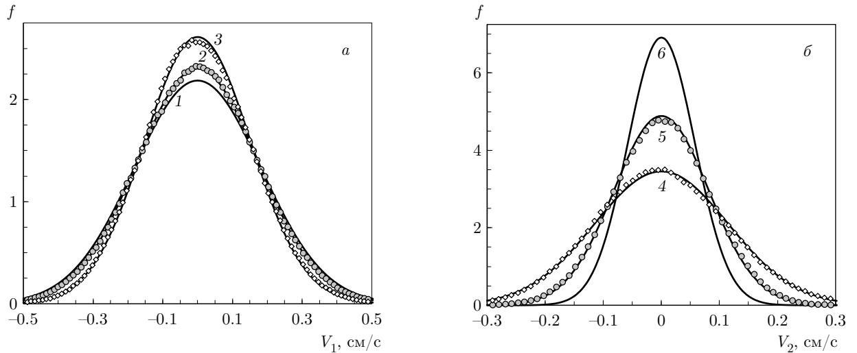
**Рис. 4.** Функции распределения скоростей для смещений отдельных частиц системы  $f_1(V_1)$  (а) и  $f_2(V_2)$  (б) в вертикальном и радиальном направлениях при  $\alpha/\beta = 4$ . Символами обозначены результаты численного моделирования, сплошными линиями — функции Максвелла с температурами:  $T_1^0 = 2.08$  эВ (1);  $T_1^r \approx 1.87$  эВ (2);  $T_1^v \approx 1.46$  эВ (3);  $T_2^v \approx 0.83$  эВ (4);  $T_2^r \approx 0.416$  эВ (5);  $T_2^0 = 0.208$  эВ (6)
