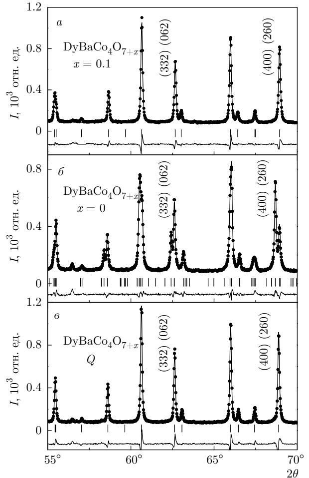
**Рис. 2.** Экспериментальные (точки) и рассчитанные (линии) рентгенограммы и разность между ними (линии внизу) для образцов  $\text{DyBaCo}_4\text{O}_{7+x}$  с разным отклонением от стехиометрии:  $x = 0.1$  (а),  $x = 0$  (б) и закаленного образца  $Q$  (в) на  $\text{Co } K_{\alpha 1}$ -излучении. Штрихами показаны положения брэгговских пиков согласно пространственной группе (для искаженного образца с  $x = 0$  приведен полный набор рефлексов для пр. группы  $Pbn2_1$ )
