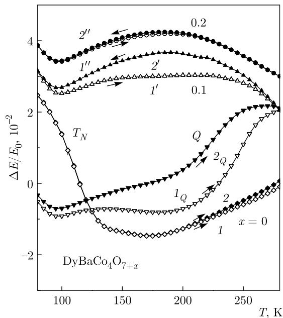
Рис. 5. Зависимость относительной величины модуля Юнга  $\Delta E/E_0$  от температуры для серии отожженных и закаленных  $Q$  образцов  $DyBaCo_4O_{7+x}$  с различным содержанием кислорода при нагреве (светлые точки) и охлаждении (темные точки). Кривые для  $x = 0.1, 0.2$  и  $Q$  смешены по вертикальной оси на произвольную величину
