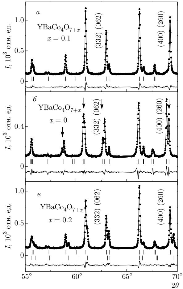
**Рис. 1.** Экспериментальные (точки) и рассчитанные (линии) рентгенограммы и разность между ними (линии внизу) для образцов  $\text{YBaCo}_4\text{O}_{7+x}$  с разным отклонением от стехиометрии:  $x = 0.1$  (а),  $x = 0$  (б) и  $x = 0.2$  (в) на  $\text{Co } K_{\alpha 1}$ -излучении. Штрихами показаны положения брэгговских пиков согласно пространственной группе (для искаженного образца с  $x = 0$  приведен «обрезанный» набор рефлексов для пр. группы  $P6_3mc$  при  $b_o \neq \sqrt{3}a_o$ )
