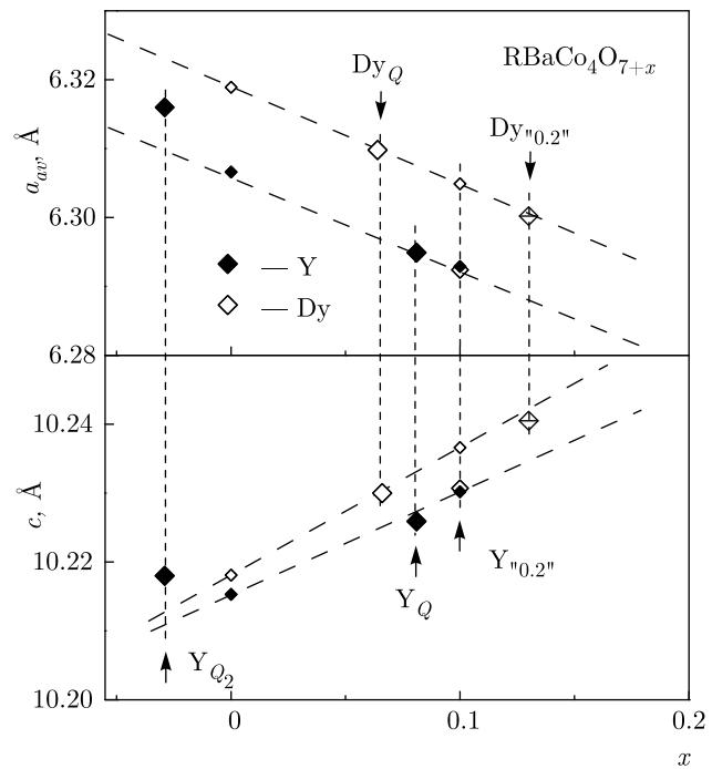
Рис. 3. Зависимость параметров ячейки  $a_{av} = (a + b/\sqrt{3})/a$  и  $c$  от избытка кислорода  $x$  для систем Y (светлые точки) и Dy (темные точки) (для закаленных  $Q$  и неоднофазных образцов — точки большего размера)
