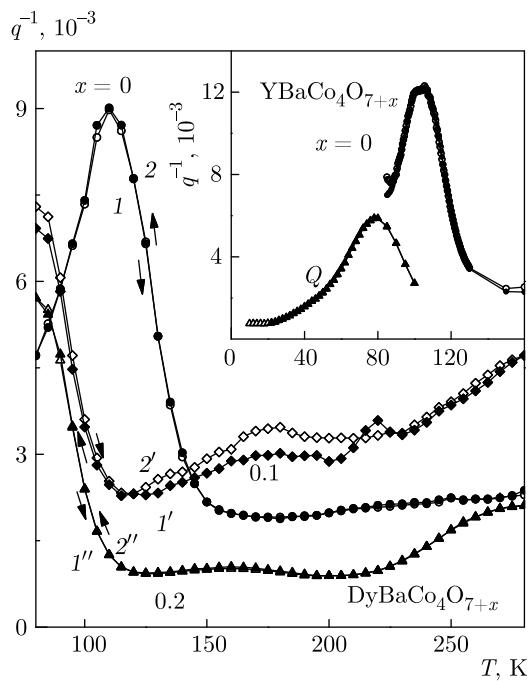
**Рис. 7.** Температурная зависимость внутреннего трения  $q^{-1}$  серии образцов  $DyYBaCo_4O_{7+x}$  с разным отклонением от стехиометрии  $x$  при нагреве (светлые точки) и охлаждении (темные точки): кривые 1, 2 —  $x = 0$ ; 1', 2' —  $x = 0.1$ ; 1'', 2'' —  $x = 0.2$ ). На вставке показано сравнение максимумов поглощения  $q^{-1}$  для отожженного с  $x = 0$  и закаленного  $Q$  образцов  $YBaCo_4O_{7+x}$  при нагреве (светлые точки) и охлаждении (темные точки)
