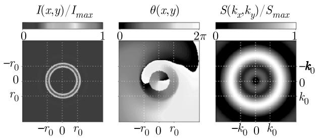
**Рис. 6.** Распределения интенсивности  $I(x,y)$  (а), фазы  $\theta(x,y)$  (б) и углового спектра  $S(k_x,k_y)$  (в) вихревого пучка при самофокусировке на расстоянии, соответствующем образованию нескольких колец в спектре
