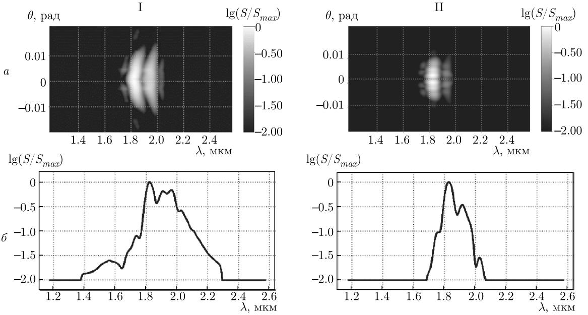
**Рис. 4.** Экспериментальные частотно-угловые (a) и частотные (б) спектры суперконтинуума филамента, в плавленом кварце фемтосекундного излучения на центральной длине волн 1850 нм для гауссового пучка (I) и оптического вихря (II). Спектры получены при небольшом превышении критической мощности в начале устойчивого режима филаментации
