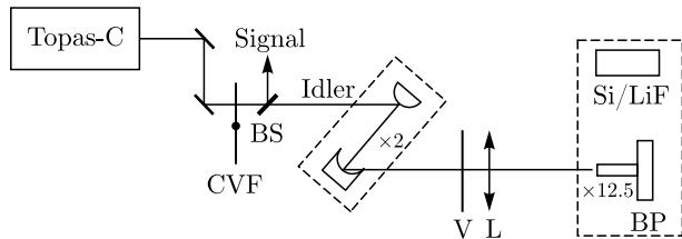
**Рис. 1.** Схема эксперимента по преобразованию гауссова пучка фемтосекундного ИК-излучения в оптический вихрь с кольцевым распределением интенсивности с помощью фазового транспаранта (V) и собирающей кварцевой линзы (L). CVF — ослабитель энергии, BS — делитель пучка. Штриховыми линиями выделены опциональные элементы схемы, описанные в тексте
