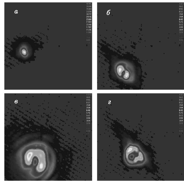
**Рис. 2.** Визуализация гауссова (*а*, без фазового транспаранта) и вихревого пучка (*б-г*) на длине волны 1800 нм в окрестности фокальной плоскости собирающей линзы с  $F = 158$  мм: *а, б* — в фокусе, *в* — перед фокусом, *г* — после фокуса
