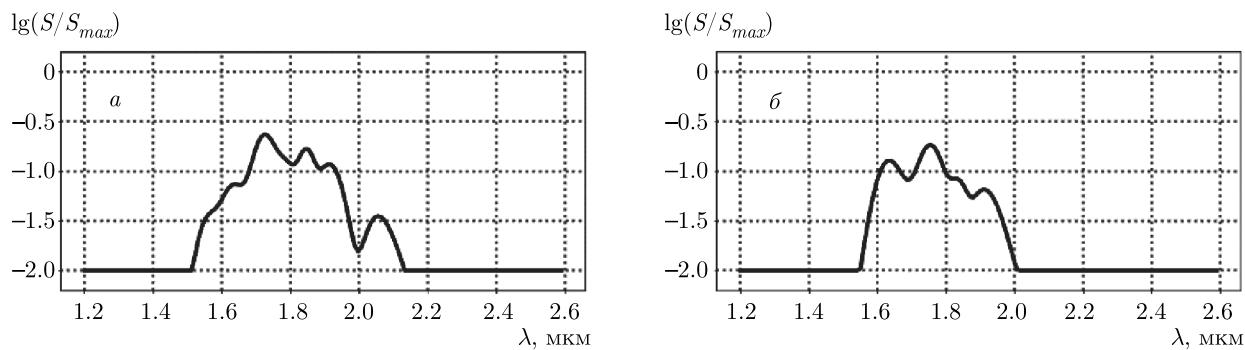
**Рис. 7.** Частотный спектр импульса на выходе из образца гауссового пучка (*а*) и оптического вихря (*б*). Численный эксперимент
