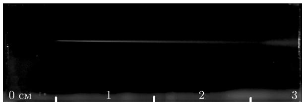
**Рис. 3.** Расходящееся излучение видимой части суперконтинуума оптического вихря в образце плавленого кварца длиной 3 см. Импульс распространяется слева направо
