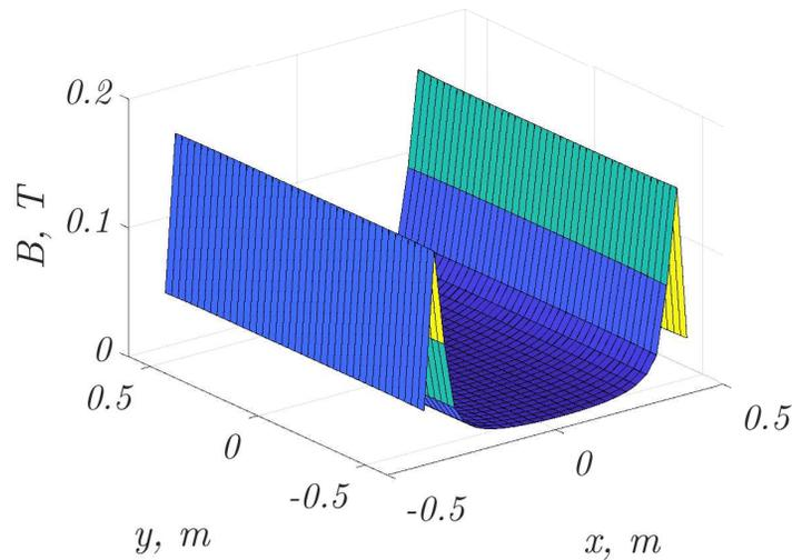
Рис. 10. Зависимость модуля индукции магнитного поля от координат  $x$  и  $y$  на расстоянии 1 мм от поверхности ведущего магнита
