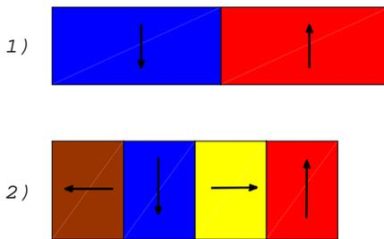
Рис. 8. Сравнение двух магнитных схем: 1) схема новой магнитной ловушки ПИЯФ, 2) схема ловушки эксперимента LANL. Стрелками показаны ориентации магнитов на длине, равной периоду магнитной структуры
