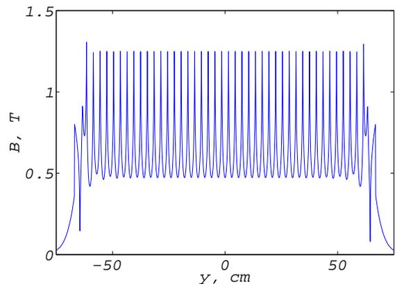
Рис. 9. Зависимость модуля индукции магнитного поля от координаты  $y$  при  $x = 0$  и  $h = 0.5$  мм
