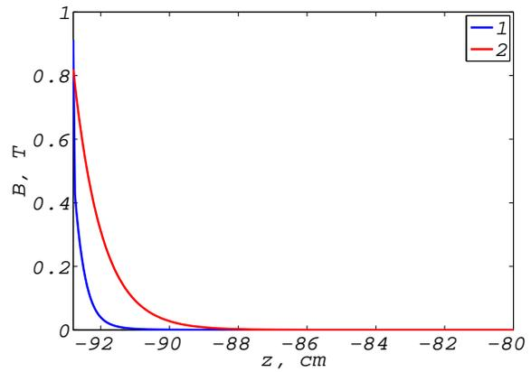
Рис. 4. Зависимость  $|B(z)|$  вдоль вертикальной прямой для двух полей — расчетного (кривая 1) и аналитического (кривая 2)
