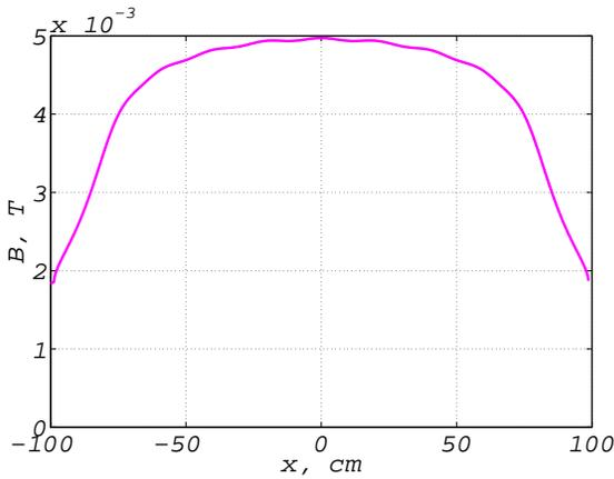
Рис. 6. Зависимость  $|B(x)|$  для внешнего магнитного поля. Поле вычислено вдоль дуги окружности, касающейся в нижней точке магнитной плоскости
