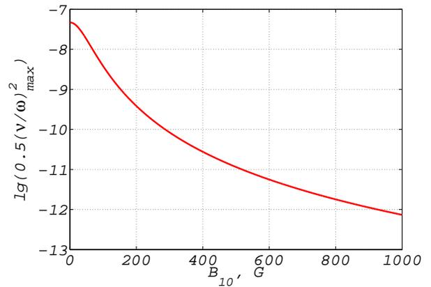
Рис. 12. Зависимость десятичного логарифма максимальной вероятности деполаризации от параметра ведущего магнитного поля для модели «аналитическое поле массива Хальбаха+ведущее магнитное поле, плоская система магнитов»
