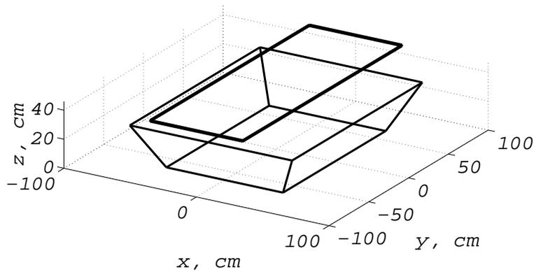
Рис. 7. Схема магнитной ловушки УХН, разработанной в лаборатории физики нейтрона НИЦ «Курчатовский институт»–ПИЯФ: четыре магнитные грани, соединенные в виде усеченной пирамиды, и ведущий магнит
