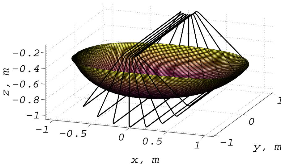
Рис. 5. Полная геометрия магнитной системы массива Хальбаха (витки, создающие ведущее поле, показаны черным цветом)
