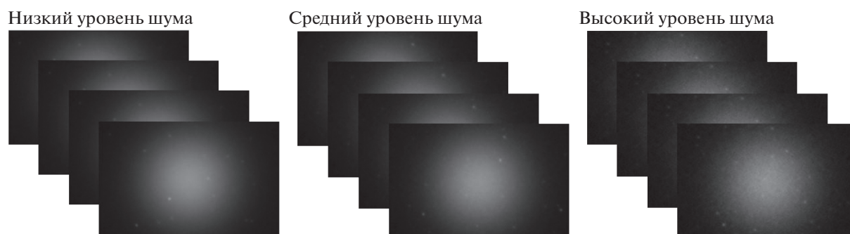
Рис. 2. Примеры изображений модельного набора данных с разным уровнем шума: низким ( 0.09 \pm 0.003 ), средним ( 0.27 \pm 0.035 ) и высоким ( 0.76 \pm 0.067 ).
