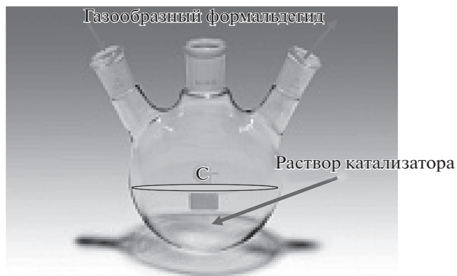
Рис. 1. Схема лабораторной установки по полимеризации формальдегида.
