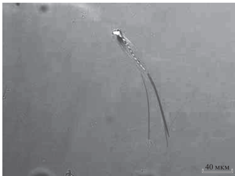
Рис. 12. Микрофотография короткой струны диаметром \sim 4 мкм, сплетенной из более тонких струн, далее практически параллельных. Раствор ТФААС в гептане.
