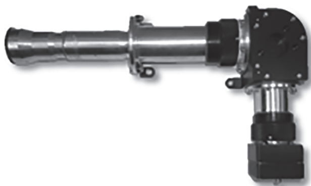
Рис. 3. Внешний вид гиперспектрометра ВИД-ИКЗ.
