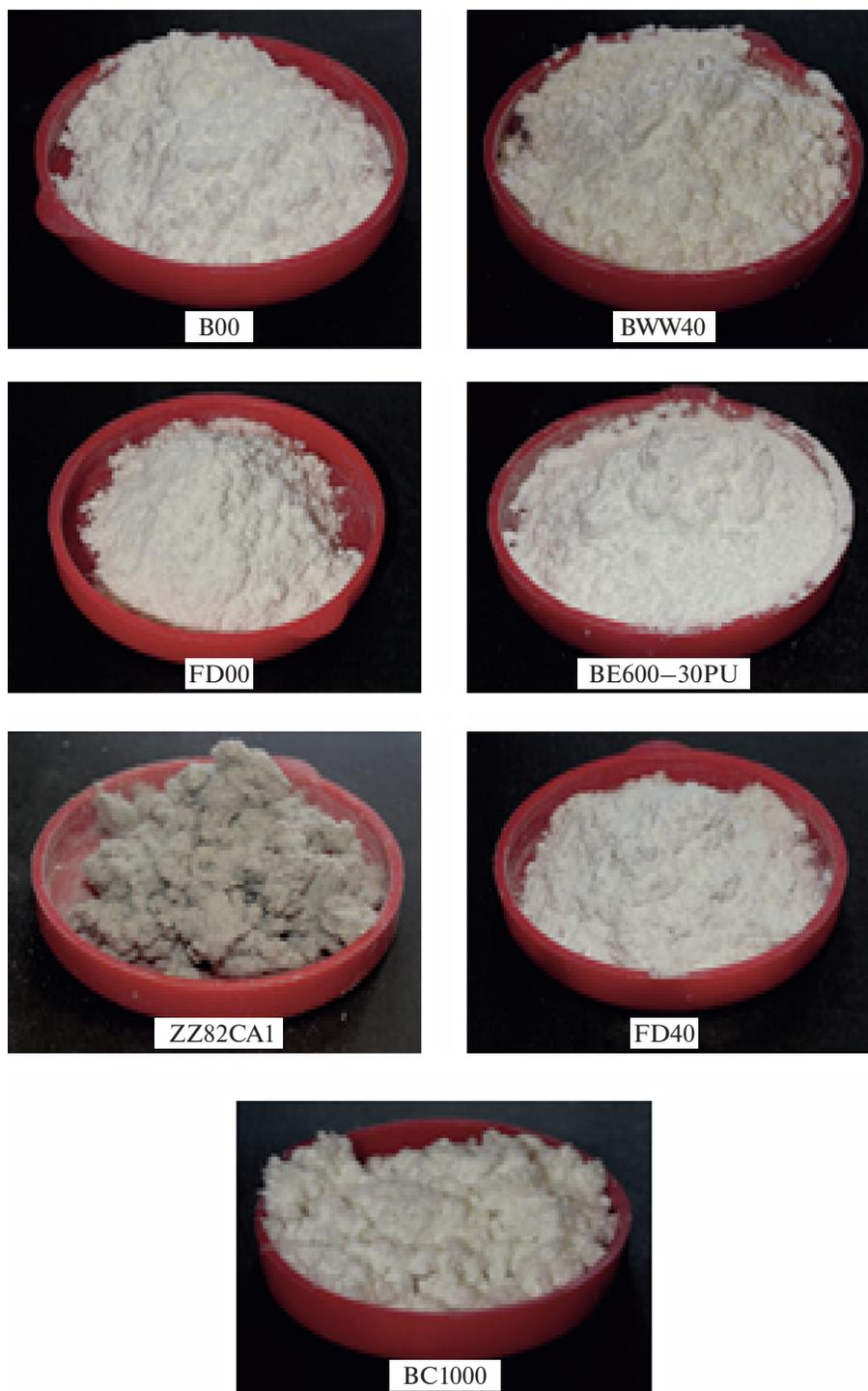
**Рис. 1.** Фотографии образцов различных марок порошковой целлюлозы ARBOCEL производства фирмы “JRS” (Германия).
