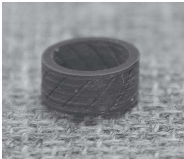
Рис. 3. Тест-объект, изготовленный из смеси “диметакрилат полиэтиленгликоля/10 вес.% кремния”.
