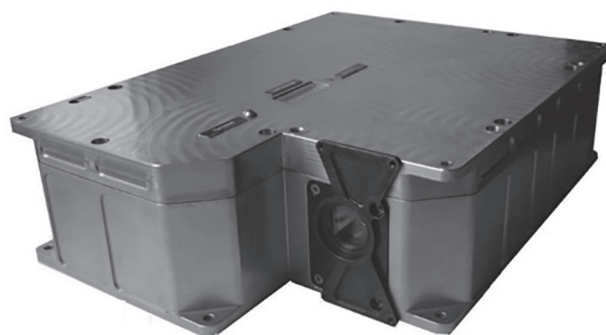
Рис. 4. Внешний вид гиперспектрометра для ближнего ИК-диапазона 900–1700 нм.
