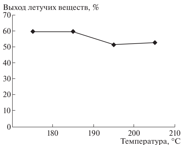
Рис. 4. Влияние температуры гидротермальной карбонизации на выход летучих веществ.
