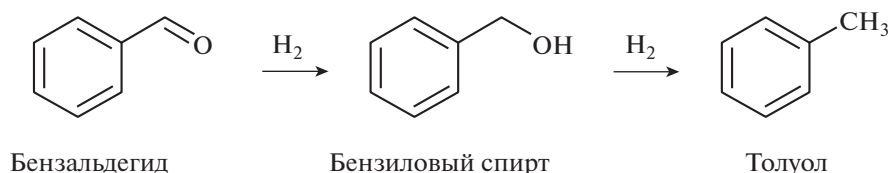
Рис. 3. Схема гидрирования бензальдегида в присутствии катализаторов Pd/С.
