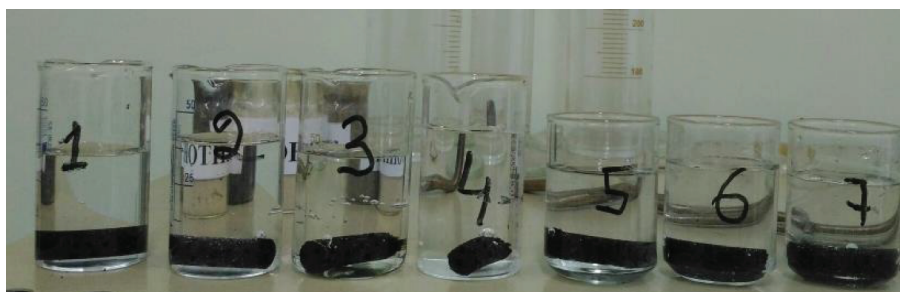
Рис. 6. Топливные брикеты, сформированные с помощью криогелей под давлением и погруженные в воду.
