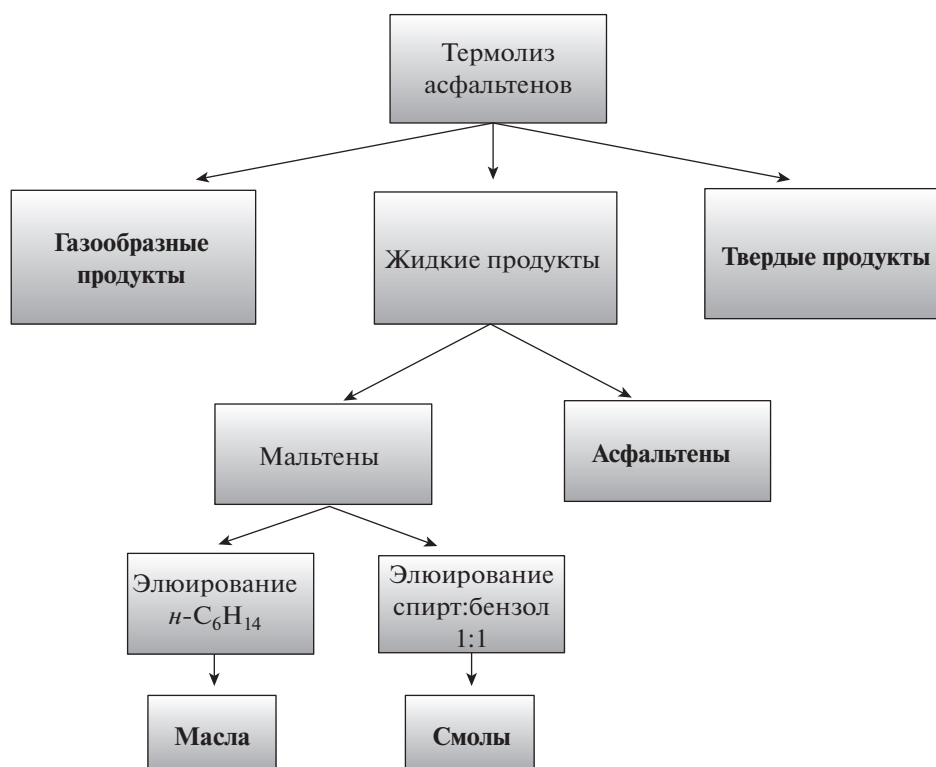
Рис. 1. Схема разделения продуктов термолиза.
