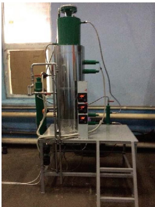
Рис. 2. Лабораторная установка газификации.
