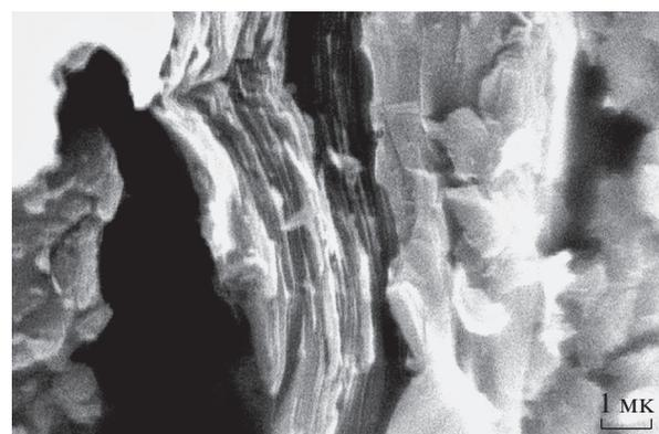
Рис. 3. Графеновые нанопластинки, прослоенные каменноугольным пеком.
